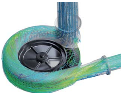
⑤ Luftströmung in der neuen Seitenkanal-Sekundärluftpumpe
